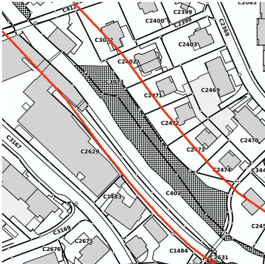
Abbildung 15: Situationsplan asymmetrische Festlegung Gewässerraum von 46 m
