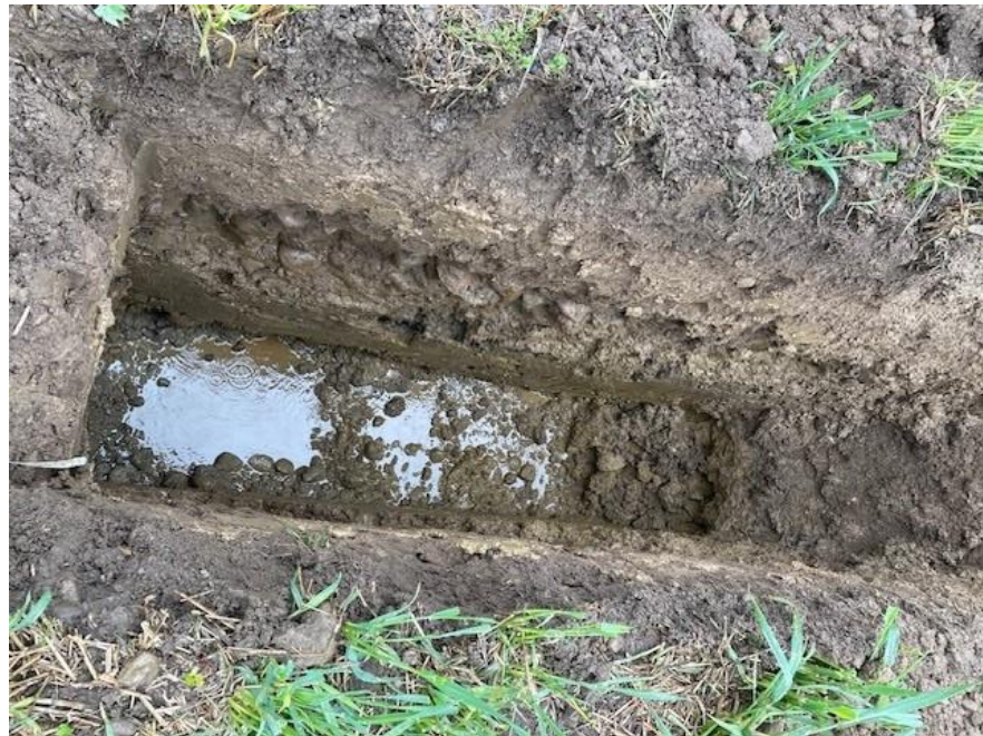
Abbildung 1: BS 25-2/VS nach Ende Versickerungsversuch, mit Ober-/Unterboden (braun, 0.0 – 0.3 / 0.6 m), darunter Gehängelehm (braun, 0.6 – 1.4 m), aufgelockerte Moräne (graubeige, 1.4 – 2.1 m) und Moränenschotter (graubeige, ab 2.1 m)
