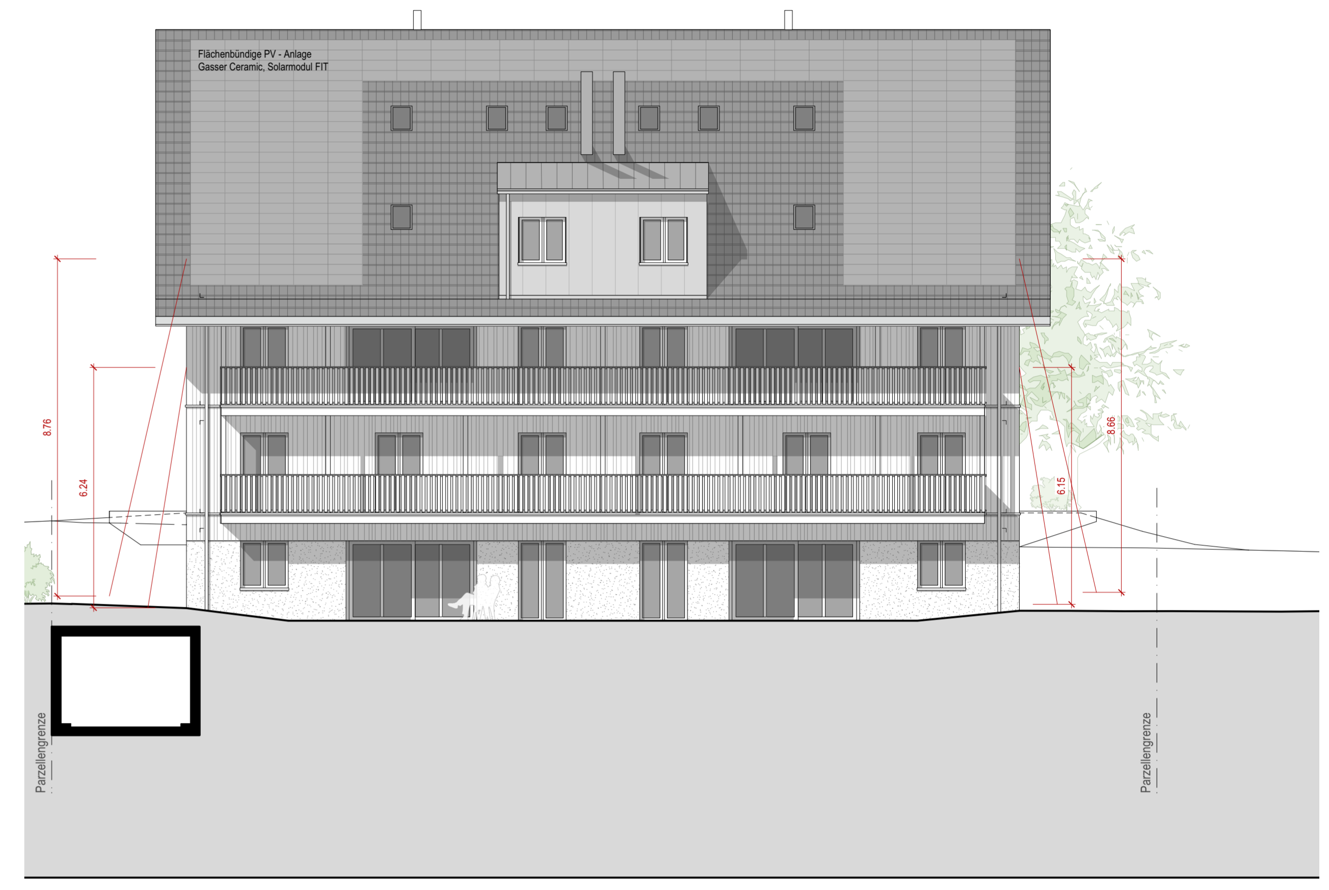
Südfassade: Schutzziel ohne Massnahmen eingehalten
