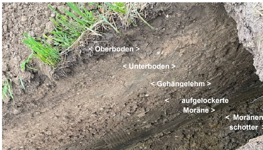
Abbildung 2: BS 25-1/P, mit Oberboden (0 – 0.3 m, braun), Unterboden (0.3 – 0.6 m, hellbraun), darunter Gehängelehm (0.6 – 1.4 m, braun), aufgelockerte Moräne (1.4 – 1.9 m, beige) und Moränenschotter (1.9 – 3.0 m, graubeige)
