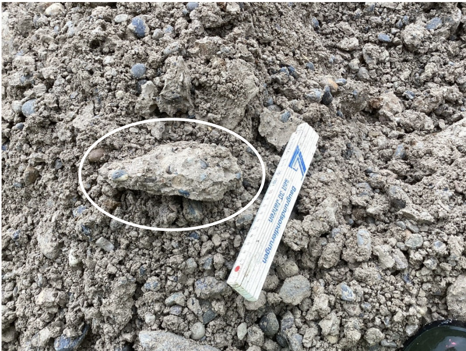
Abbildung 5: Sehr dicht gelagerte Moräne aus Feinsand / Silt im Handstück, aus BS 25-3/P
