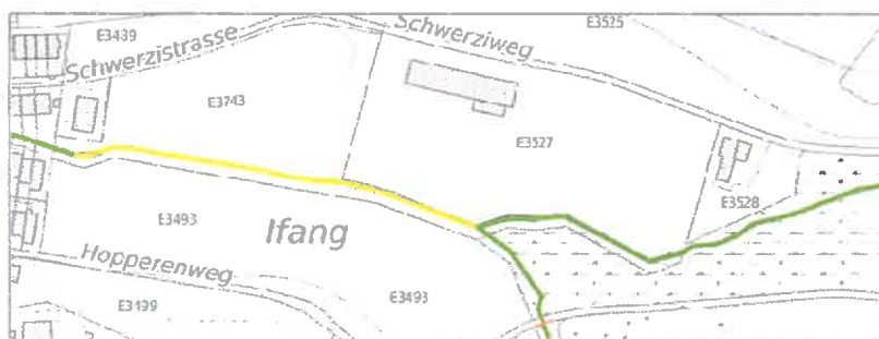
Abbildung 19: Ökomorphologische Kartierung des Projektabschnittes. Gelb = stark beeinträchtigt. Grün = wenig beeinträchtigt (GIS ZH, April 2021)
