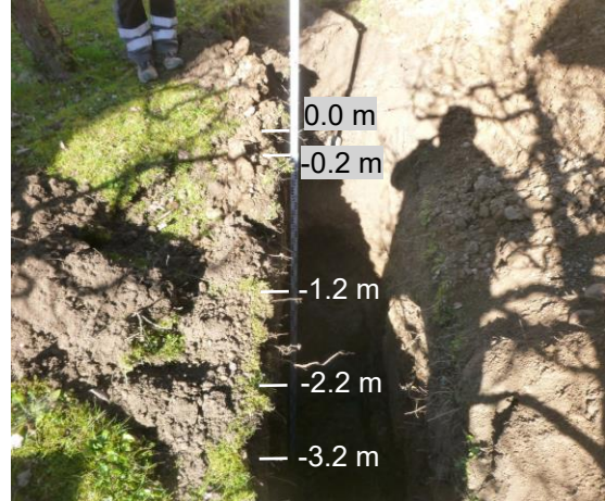
BS1 kurz vor Endsondiertiefe
