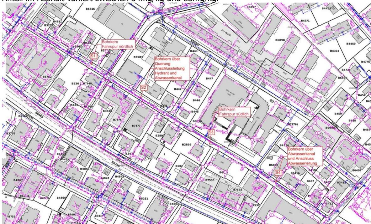
Abbildung 15: Bohrkernplan (Quelle: Bericht Consultest AG 11.04.2024)
