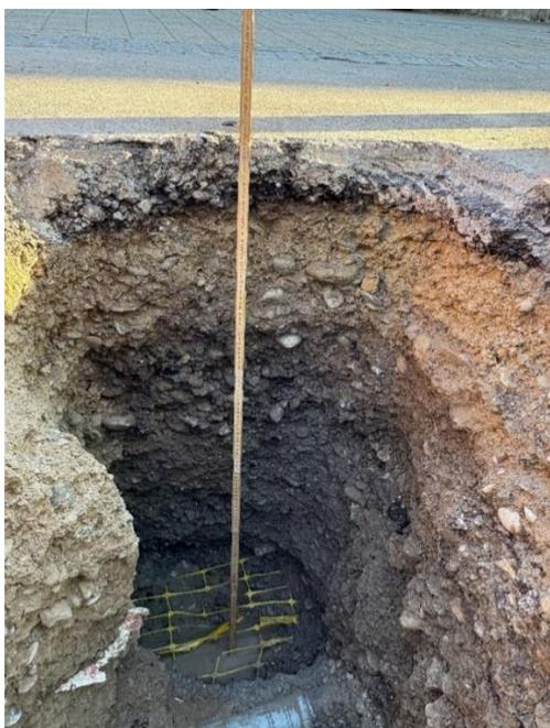
Abbildung 18: Sondage B Aufbau Bodenuntergrund (Quelle: INSTRAG Bauingenieure AG)
