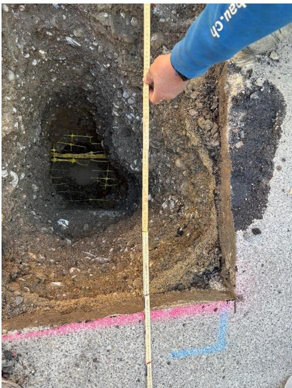
Abbildung 21: Sondage E Aufbau Bodenuntergrund (Quelle: INSTRAG Bauingenieure AG)
