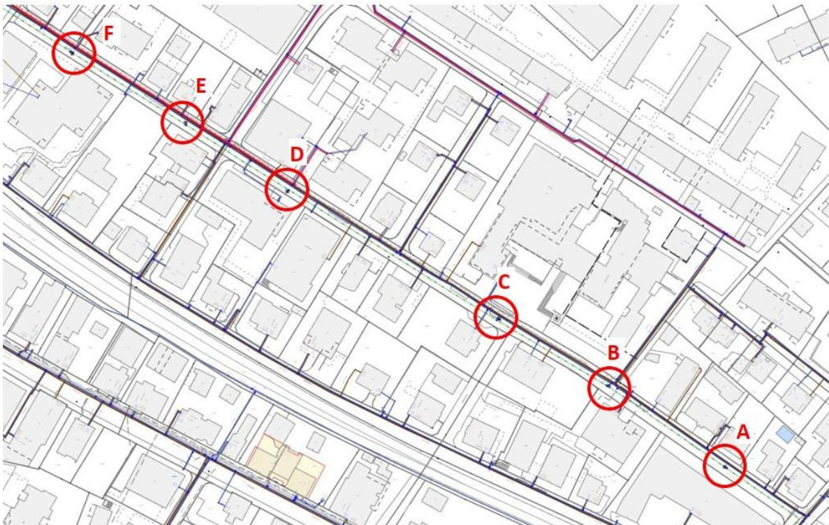
Abbildung 16: Sondageplan Sondierung Hochdruck Gasleitung (Quelle: Energie Uster AG)
