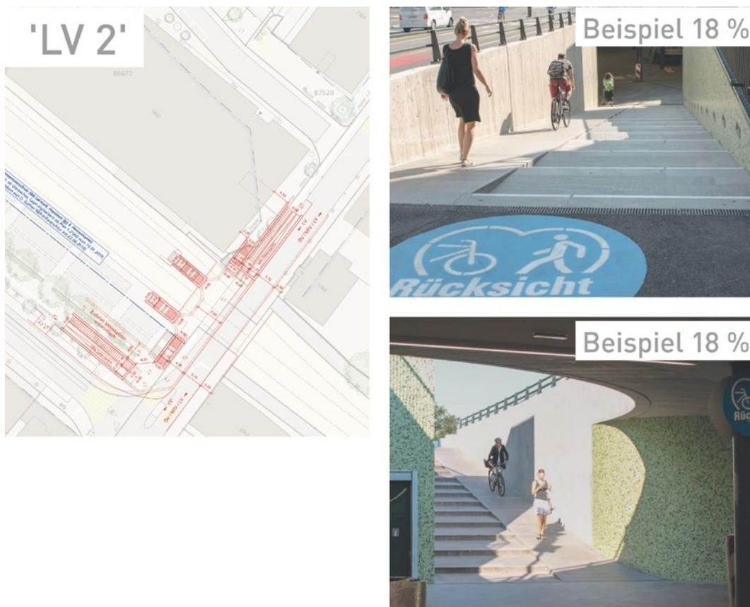
Abb. 64 Lösungsansatz «LV 2» mit Beispielen einer Rampe mit 18% Gefälle (Darstellung: asa AG)
