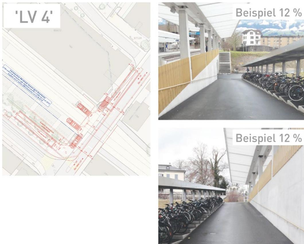
Abb. 66 Lösungsansatz «LV 4» mit Beispielen einer Rampe mit 12% Gefälle (Darstellung: asa AG)
