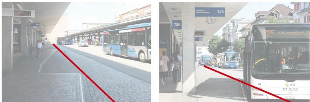
Abb. 30 Umbau heutige «Sägezahnordnung» zu langen «Fliesskanten» wäre notwendig (Darstellung: asa AG)
