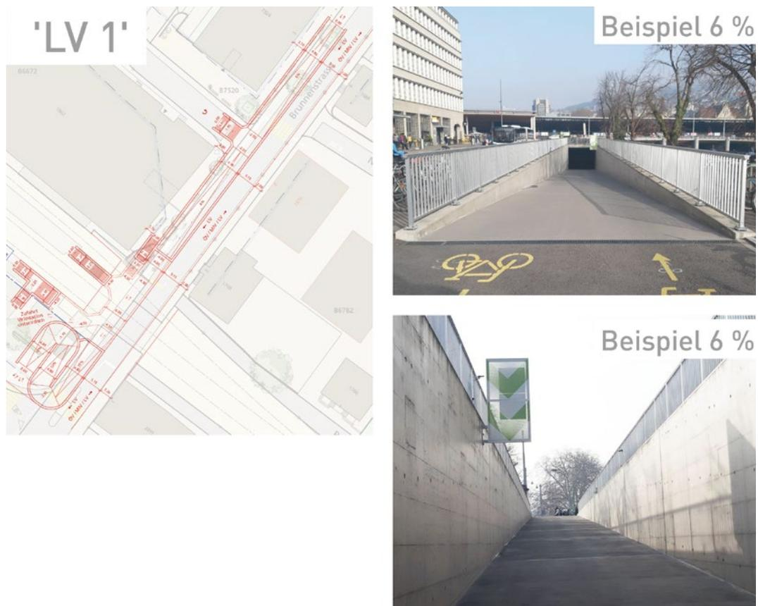
Abb. 63 Lösungsansatz «LV 1» mit Beispielen einer Rampe mit 6% Gefälle (Darstellung: asa AG)
