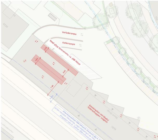
Abbildung: Veloparkierungsanlage im Hochparterre (Verladeplattform) (Darstellung asa AG)
