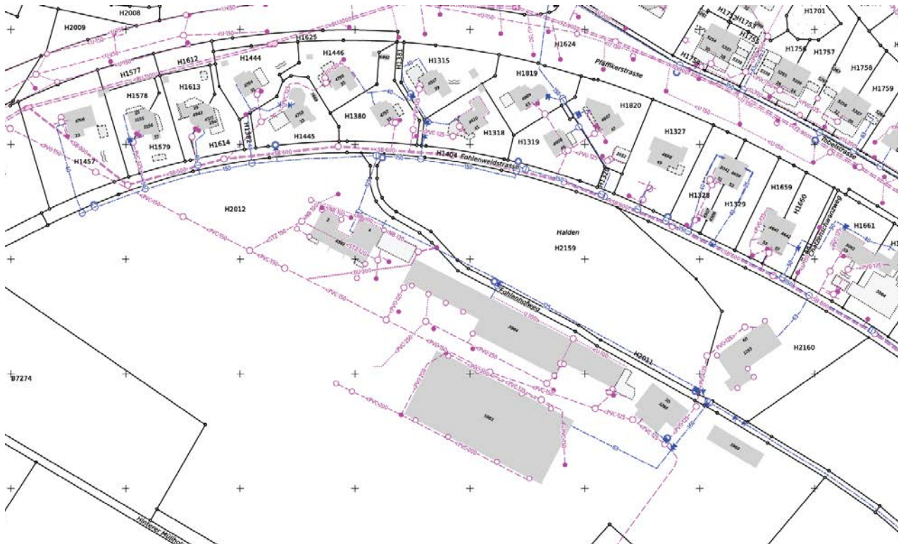
Ausschnitt Werkleitungskataster, 30.7.2018 (blau: Wasserversorgung / violett: Entwässerung)
