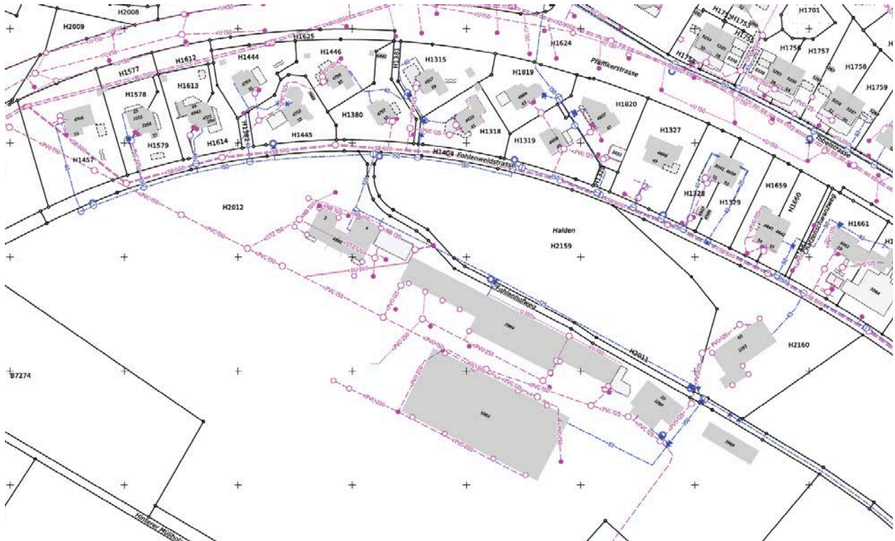
Ausschnitt Werkleitungskataster, 30.7.2018 (blau: Wasserversorgung / violett: Entwässerung)
