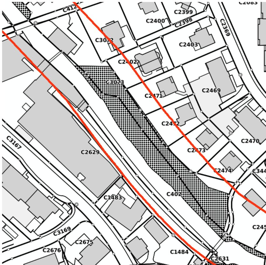
Abbildung 18: Situationsplan asymmetrische Festlegung Gewässerraum von 46 m
